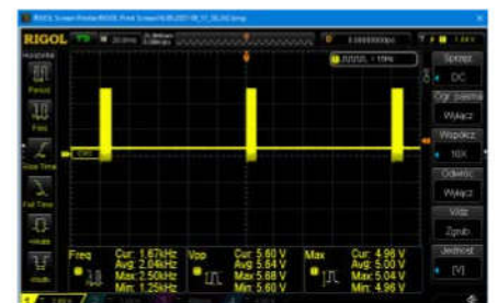
Rysunek 6. Prawidłowy oscylogram na wyjściu interfejsu RS485
